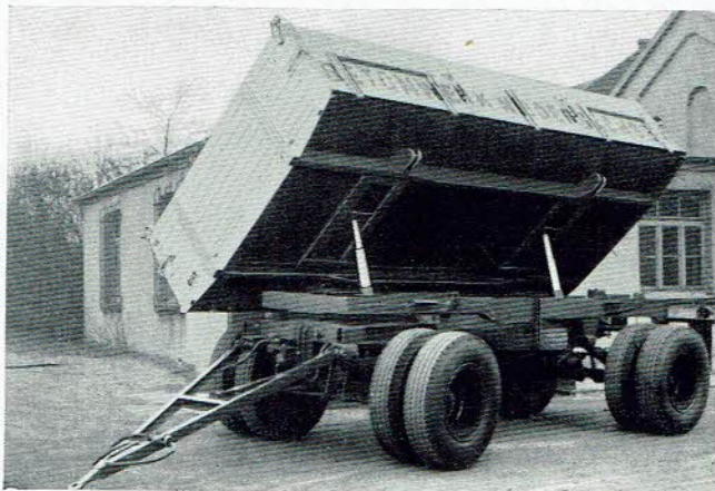
12-t-Zweiseiten-Kippanhänger, hand- und motorhydraulisch
