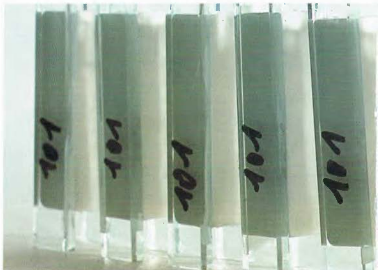
Rechts: Prüfung der Standfestigkeit von Sista-Fugendichtungsmassen.
