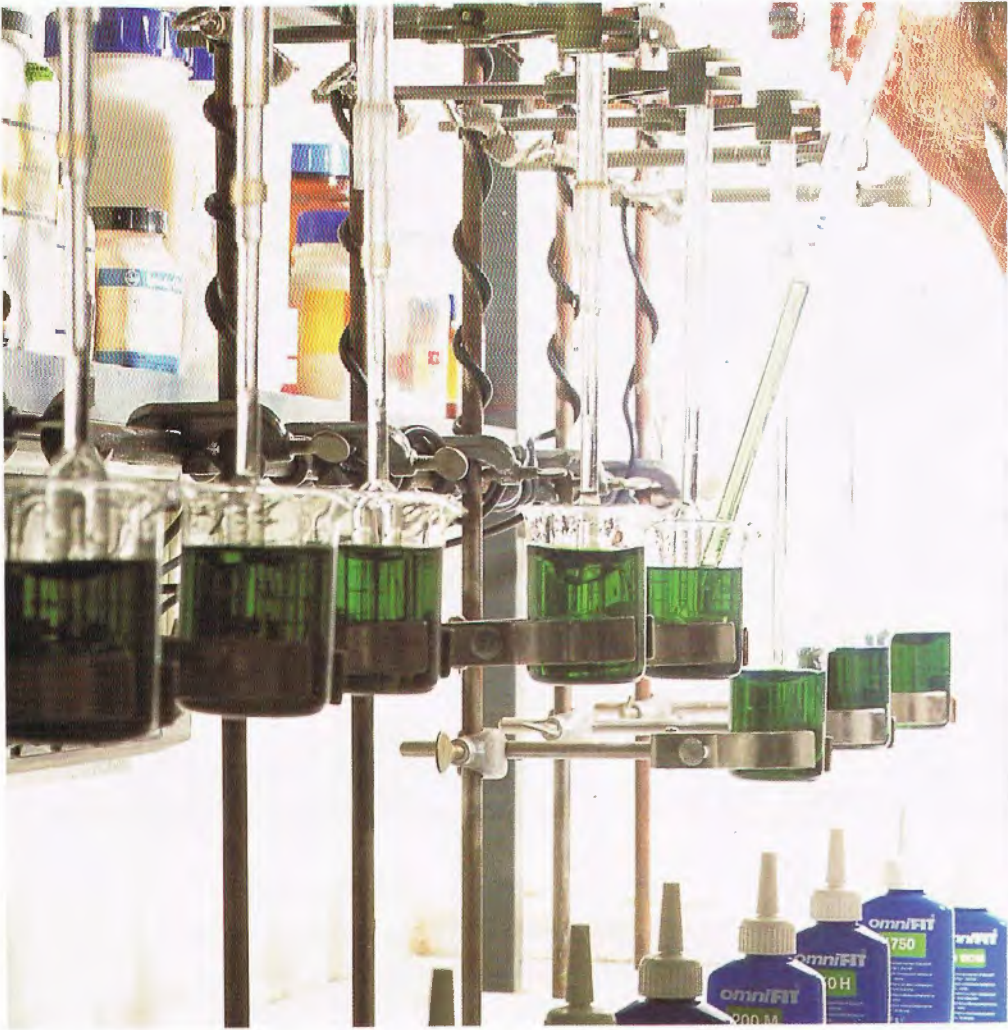
Rührwerke für Reihenversuche von anaeroben Kleb- stoffen.
